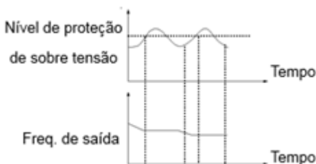
Fig.6-31 Proteção de sobre tensão
